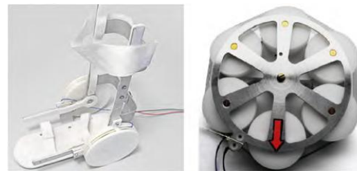
شکل ۶- یک محرک دوار NiTi برای ارتز مچ پا [20].
