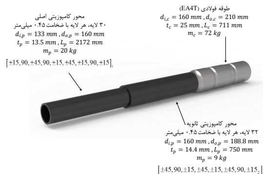
شکل ۵: اکسل کامپوزیتی طراحی شده در تحقیق حاضر و جزئیات آن
