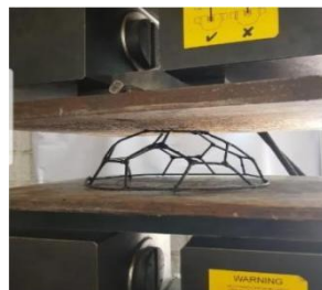
شکل (۳) نمونه نیم‌کروی فلزی لانه‌زنبوری در حین تست لهیدگی جانبی
